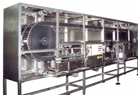
Ополаскиватель с индивидуальным приводом, зоной промывки пустых банок – корзины вращения (спирали, вращатели банок) –
