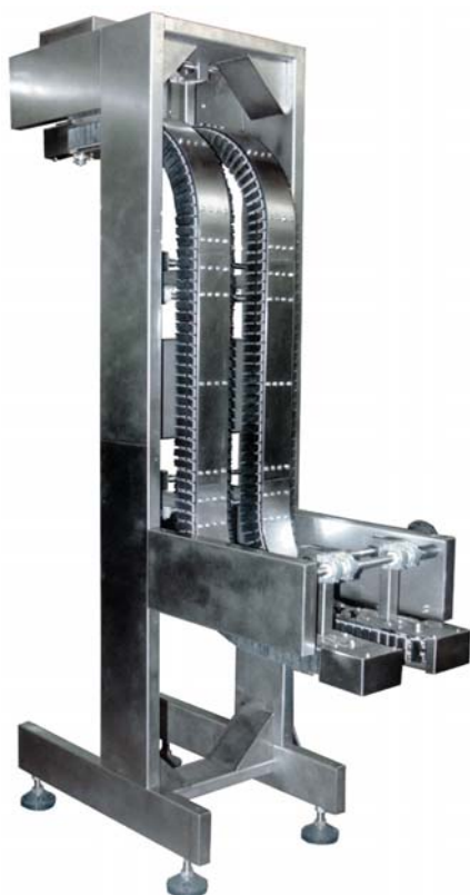
Зажимные транспортёры, элеваторы – вертикальная транспортировка при большой производительности –
